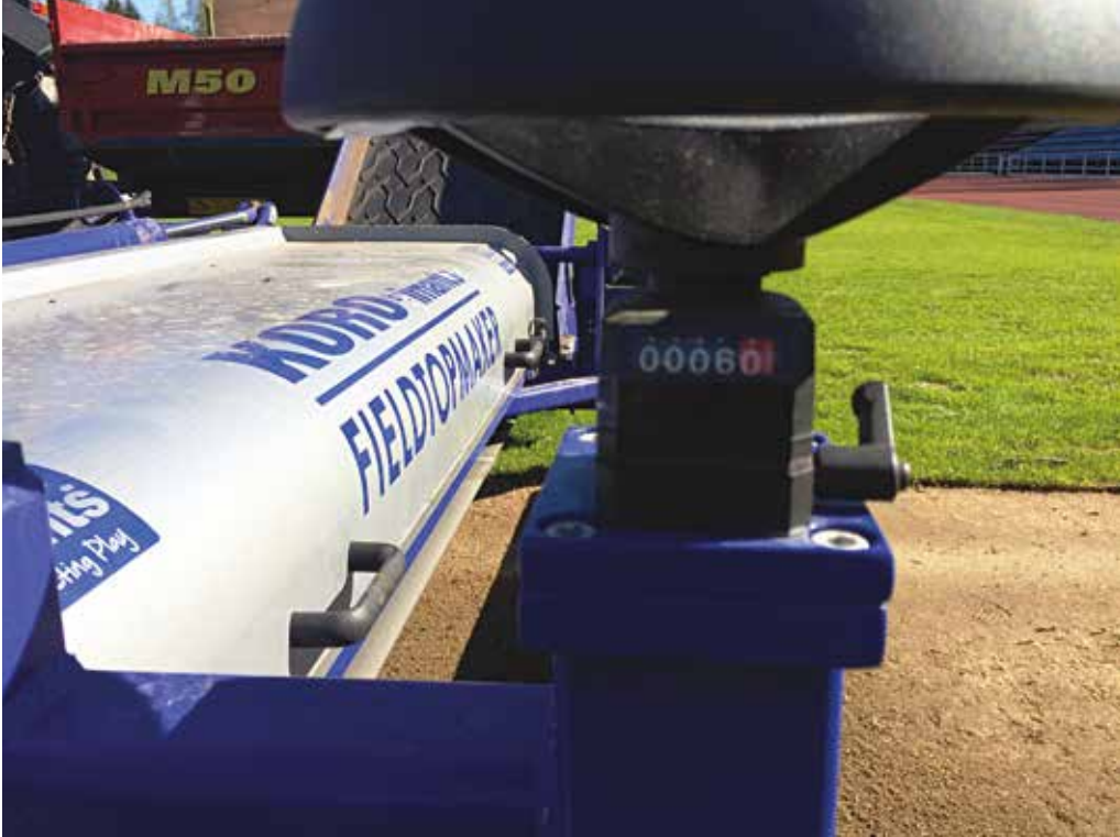
Установка глубины с точностью до 0,1 мм на цифровом дисплее
